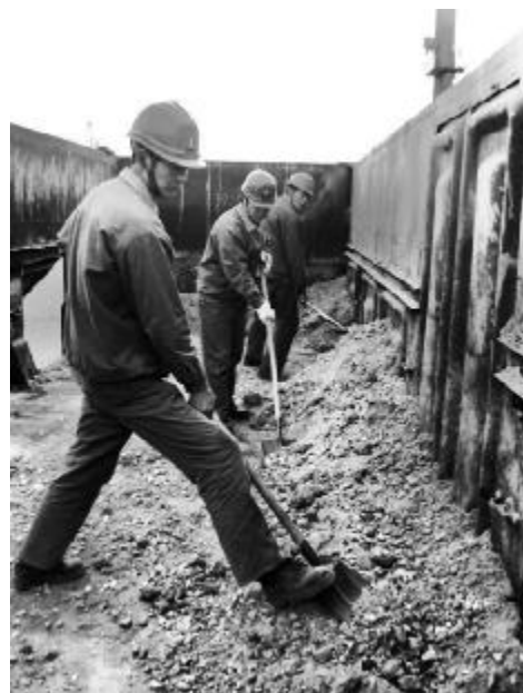
12月6日，进厂铝土矿专列铝土矿上冻，经翻车机翻卸后，还有一部分铝土不能卸干净，为确保铝土矿颗粒归仓，氧化铝一分厂一车间党员干部和生产骨干组成突击队，第一时间投入铝土矿冻料的清理，经过3个小时的奋战，累计清理铝土冻块30余立方。同时，分厂又从各车间抽调人员对夜间车皮中的冻块进行了清理。图为铝土冻块清理现场。摄影报道 郭海斌
