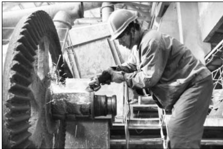
检修分厂修造车间经过连续十天努力,采用手工研磨技术,于7月6日成功修复氧化铝磨头。图为钳工技师李奇在精心研磨轴头。摄影报道 张安泽
