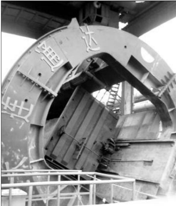
9月3日,在翻车机改造现场,一节满载铝土矿的70吨重车皮顺利进入翻车机,成功翻卸。这标志着二期翻车机改造试车圆满成功。图为改造后翻车机进行第一节车皮翻卸。摄影报道 郭海斌
