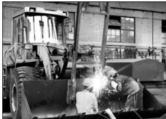
近日,检修分厂成功为装载机加装了专用卸矿推板,增加了卸车功能,大幅度降低了人工卸车劳动强度,使人工卸车10人3个小时的劳动时间缩短为20分钟。图为检修员工正在改造装载机。 摄影报道 昌莲 李明 安泽
