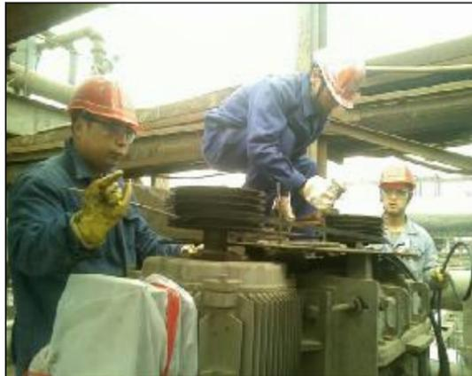
近日，第一氧化铝厂分解车间对特大型重点设备种分槽开展一季度普查。车间组织电器队、钳工队、清理队密切配合，分工协作，经过三个半小时的紧张工作，共处理电器隐患16项，更换三角带32条，更换了2台减速机润滑油，确保了特大型设备的稳定运行，为三月份生产任务的顺利完成创造了良好的条件。图为检修工正在更换种分槽减速机三角皮带。摄影报道 柴菊珍
