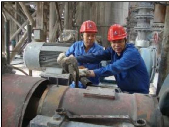
近日,第一氧化铝厂分解车间钳工队党支部积极参与党员带头消除浪费活动,针对种分系统17台同型号的种子泵频繁检修现象,党员闫效伟带领队员,将“降低种子泵返修率”作为党员带头消除浪费改善点进行实施改善,通过加大设备点巡检及维护保养力度,加强业务知识培训,提高检修质量,杜绝了种子泵返修现象,每年可节约检修费用3.2万元。图为钳工队员工正在更换种子泵对轮。
