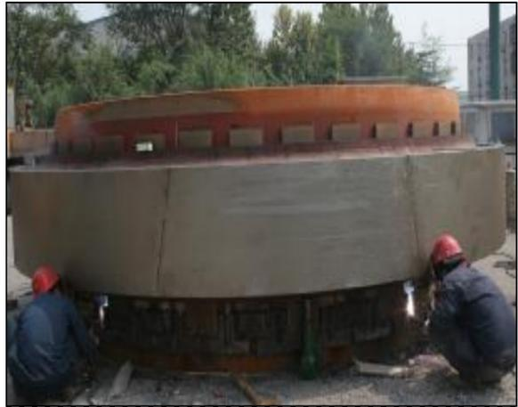
图为施工人员正在对新领圈进行焊接组装。
