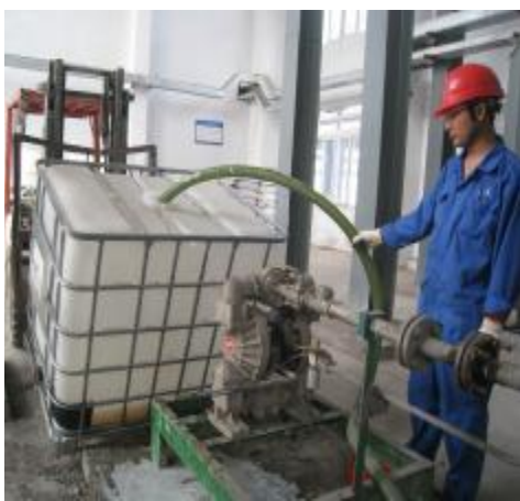
图为精制车间员工正在添加絮凝剂。
