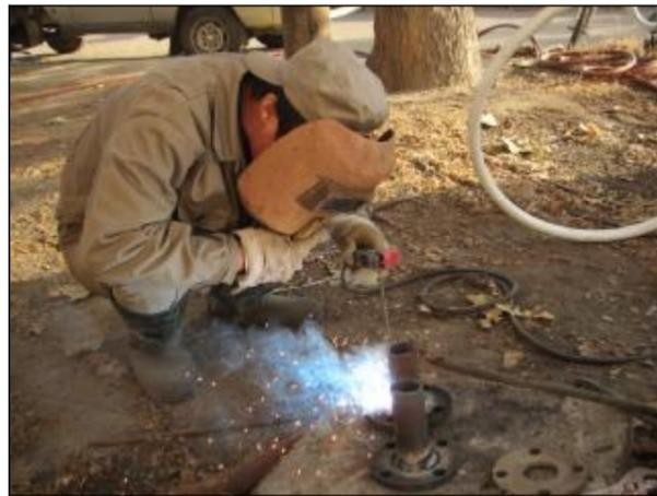
近日，为进一步降低阀门购置成本，生活服务中心维修二车间借助运营转型开展小技改对阀门进行修旧利废，他们组织管工班根据不同规格的失灵阀门特点，经过反复探索、试验，分别确定了闸阀、蝶阀等不同规格阀门丝杆、闸板等易损零部件的修旧利废方法，每年节省阀门购置费用1万余元。图为该车间技术人员利用废旧钢管自制法兰。 摄影报道 王海雷
