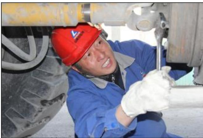
近日,第一氧化铝厂原料车间机械班加强对装载机等大型装卸设备进行检修维护。机械班员工除每日对铲斗、大臂、小臂、传动轴、液压系统等裸露在外的部位进行清理和润滑小维护外,每周对车辆制动系统、防冻液、传动油等关键部位的油质、油位进行检查更换,主动承担除发动机外的各种检修任务。图为机械班员工正在紧固装载机传动轴螺丝。
