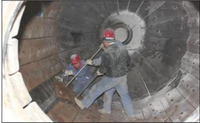
3月12日,晋铝建安公司检修车间员工在第二氧化铝厂5号原料磨检修过程中,兵分三路,衬板更换、传动轴承检查加油、螺栓紧固三个环节交叉作业,明显提高施工进度。图为施工人员在磨体内更换衬板。摄影报道 杨鹏霞
